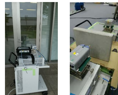
様々な実環境での測定(左)と各種建材の透過特性測定(右)
